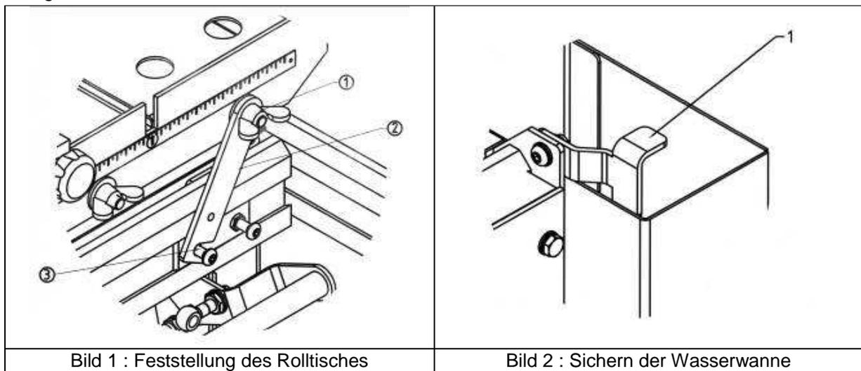
a) Wenn Sie die Maschine montiert transportieren wollen, müssen Sie den Rolltisch und die Wasserwanne sichern:
